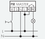
Dauerlichtbetrieb mit externem Schalter
